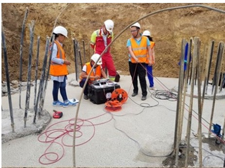
Fig. 4. «Cross-Hole-Sonic-Logging» - at LRT site.
