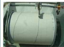
変動が激しい伸縮計の記録例(24時間巻き) (70mm以上/16時間)
