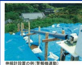
伸縮計設置の例(警報機運動)
