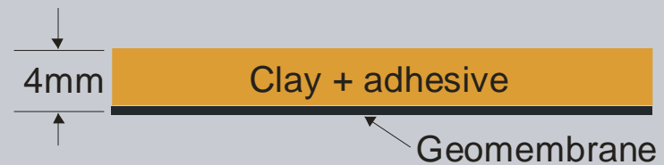
(d) Adhesive bound clay to a geomembrane
